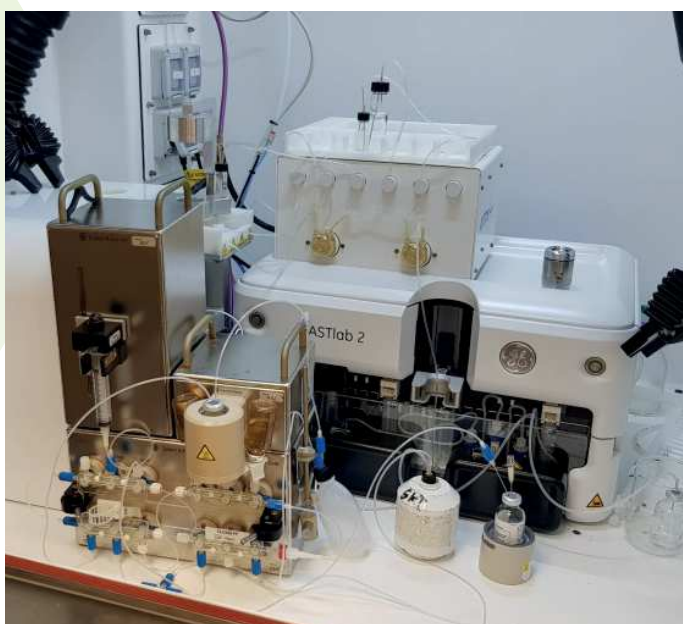
Hotcellen med det fuldautomatiske udstyr til radiokemisk separation af ^{68}\text{Ga} og ^{68}\text{Zn} og efterfølgende radiomærkning/syntese.
