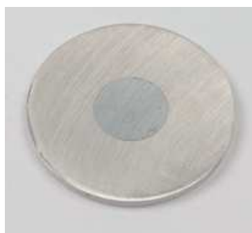
Beriget ^{68}\text{Zn} target før bestråling.
