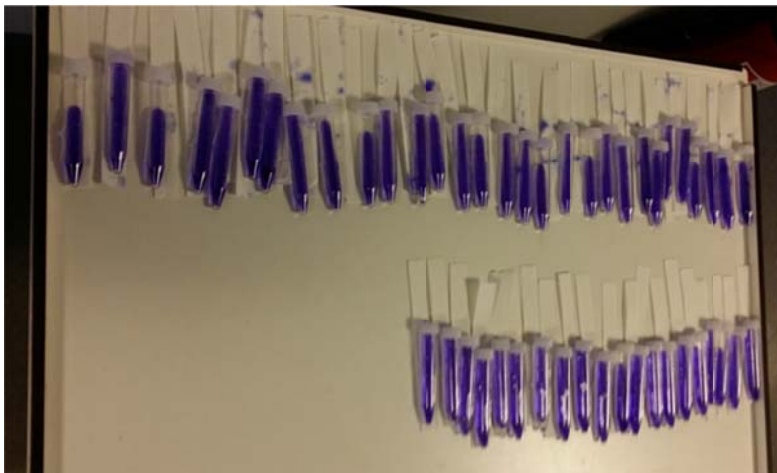
På billedet ses øverst de 30 utætte rør, nederst de 10 tætte rør.
