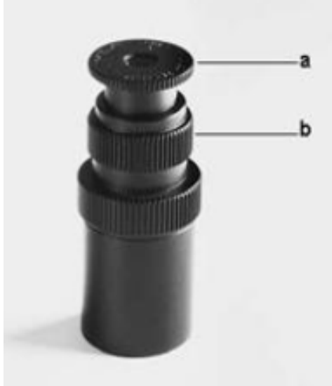
Fig. 3 - Hjælpeokular a: Linse b: Låsering
