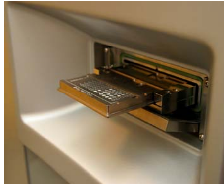
Massespektrometri vha. MALDI-TOF
